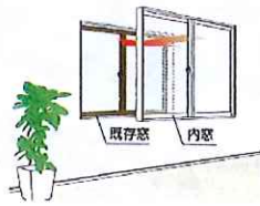
既存窓の内側に新たな窓を設置
